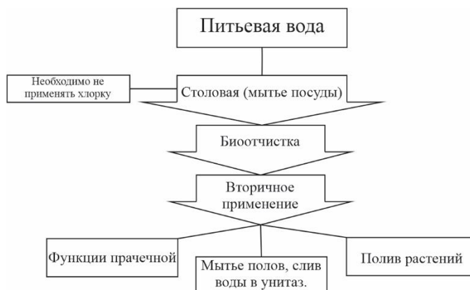
Рисунок 4 – Этапы обработки питьевой воды для вторичного применения
