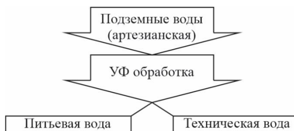
Рисунок 3 – Последовательность процесса подачи воды для обработки лампой УФ излучения
