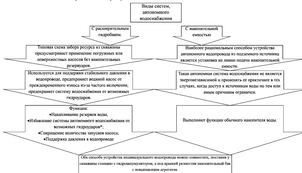
Рисунок 2 – Виды систем автономного водоснабжения для автомойки: устройство и технологические этапы
