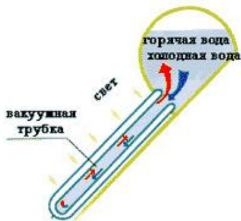
Рисунок 3 - Вакуумный солнечный водонагреватель-коллектор магистрального давления, термосифон со встроенным теплообменником
