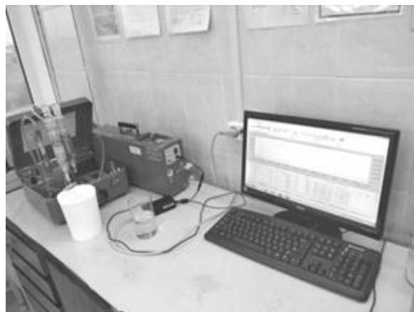
Рисунок 3 – Анализатор ртути РА-915+ в комплекте с приставками РП – 91 и РП-91С
