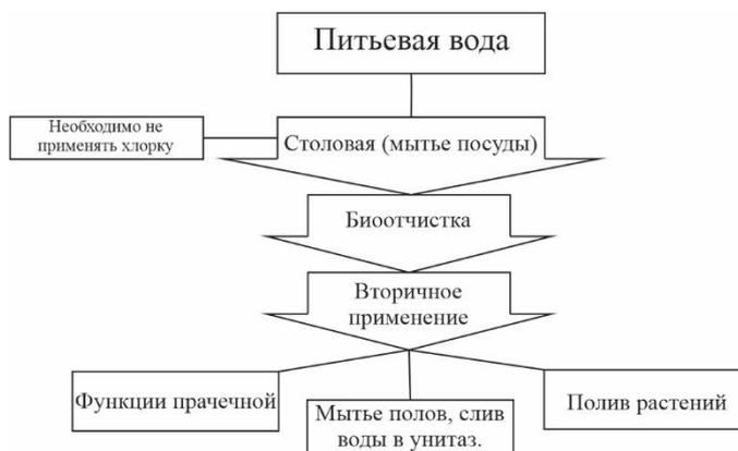
Рисунок 4 – Этапы обработки питьевой воды для вторичного применения
